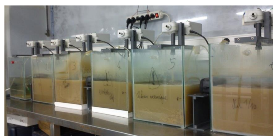
Tests de dégradation en milieu contrôlé (bouchon vaseux de la Gironde)
