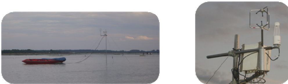
Figure 60 : Bassin d'Arcachon, 2008. Acquisition in situ des flux de CO 2 avec le système d'eddy-covariance (G. Abril, P. Posenaere, UMR EPOC)
