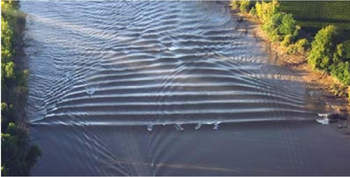
Fig. 1 : Illustration de la forme caractéristique des *RM* ondulés de forte intensité (*i.e. mascarets*) dans la Garonne. Photo aérienne réalisée le 10 septembre 2010 à 500 m en aval de notre site de mesure de Podensac. La largeur du plan d'eau, à basse mer, est de 145 m.  $T_R=6.3$  m (marnage sur site),  $F=1.26$ .
