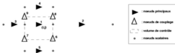
Figure 3.5 : Schéma de définition du schéma suivant  $x$ .
