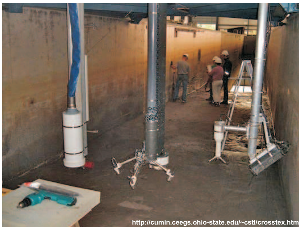
FIG. 7.4 – Dispositif de mesure dans le canal à houle; de gauche à droite : Sonar (Imagenex) et PIV laser (Dantec), vélocimètre cohérent bi-statique, puis ADV (Sontek) et vidéo.
